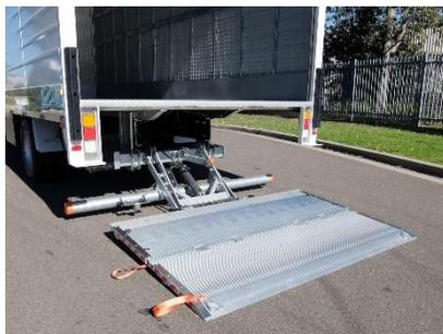
**Rampa con plataforma de columna.** Rampa DHollandia, de columna con capacidades desde 1000 a 2500 Kg. Rampa retráctil instalada debajo de la unidad la cuál no afecta el enrampe de las unidades en el andén.
