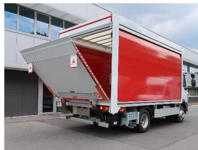
**Rampa con plataforma plegable o retráctil.** Rampa DHollandia, el caballo de batalla con capacidades desde 1000 a 2500 Kg. Rampa retráctil instalada debajo de la unidad la cuál no afecta el enrampe de las unidades en el andén.
