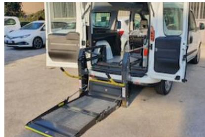
**Rampa angosta para cargas ligeras.** Rampa DHollandia con plataforma pequeña para subir cargas de hasta 500kg. Compacta y ligera para ascenso y descenso de racks con llantas o diablitos.
