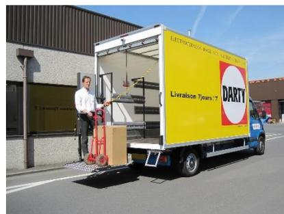
**Rampa con plataforma amplia** . Rampa DHollandia con plataforma amplia utilizado incluso como puerta de carrocería. Muy útil para bajar tarimas con patin eléctrico o manual
